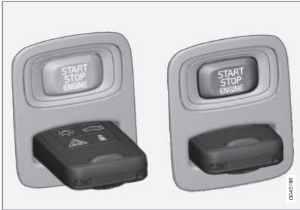
Zündschloss mit herausgezogenem/ingedrücktem Transponderschlüssel.
