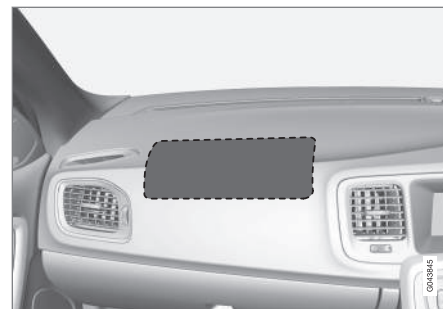
Position des Beifahrerairbags in Rechtslenkern.
