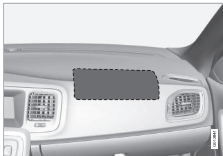
Position des Beifahrerairbags in Linkslenkern.
