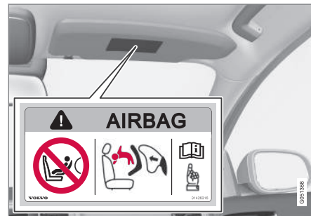
Möglichkeit 1: Airbagaufkleber an der Sonnenblende auf Beifahrerseite.
