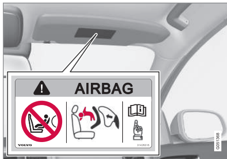
Möglichkeit 1: Airbagaufkleber an der Sonnenblende auf Beifahrerseite.
