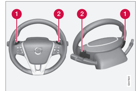
Die beiden "Schaltwippen" des Lenkrads.
