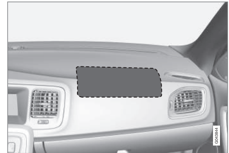
Position des Beifahrerairbags in Linkslenkern.
