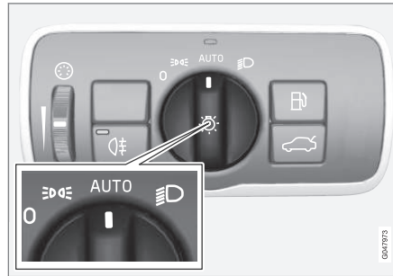
Drehregler des Lichtschalters in Stellung AUTO .
