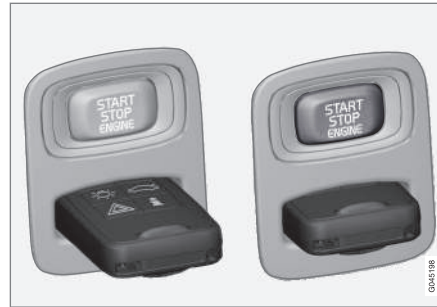
Zündschloss mit herausgezogenem/eingedrücktem Transponderschlüssel.
