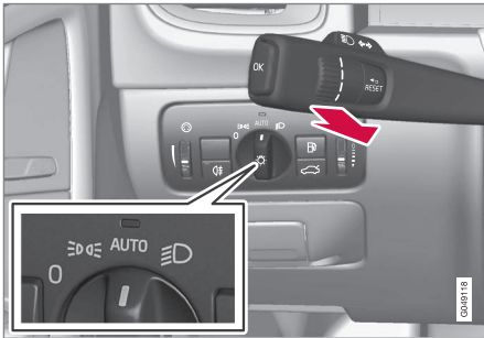
Lenkradhebel und Lichtschalter-Drehregler in Stellung AUTO .
