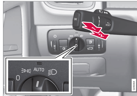
Lenkradhebel und Lichtschalter-Drehregler.
