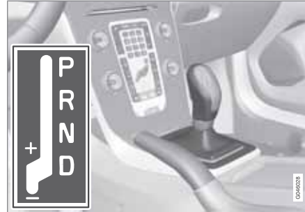
D: Automatische Gangstellungen. +/-: Manuelle Gangstellungen.
