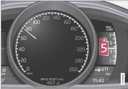
Armaturenbrett "Digital" mit Schaltanzeige.
