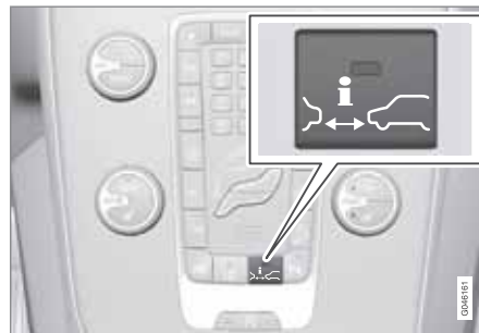
Bedienelemente und Display für Zeitabstand.
