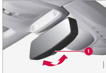
1 Hebel für Abblendung
