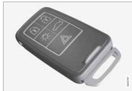
Transponderschlüssel mit 5 Tasten
