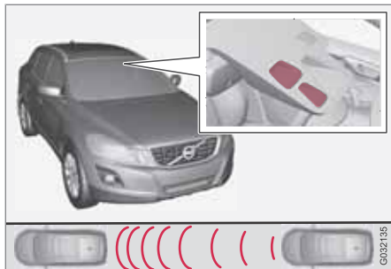
Sender- und Empfängerfenster des Lasersensors 1 .
