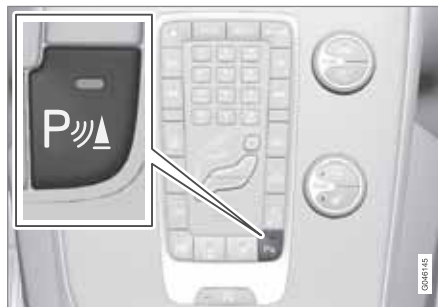
Ein/Aus der Sensoren der Einparkhilfe und von CTA 1 .
