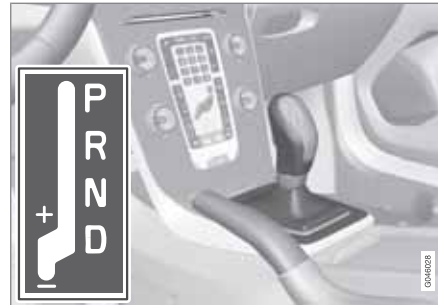
D: Automatische Gangstellungen. +/-: Manuelle Gangstellungen.
