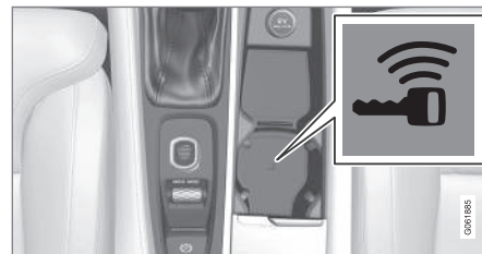
Lage des Schlüssellesegeräts in der Tunnelkonsole.
