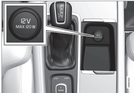
12-V-Steckdose in der Tunnelkonsole, vorn.
