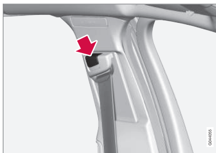
Höhenverstellung des Sicherheitsgurtes. Die Taste drücken und den Gurt in der Höhe verstellen. Den Gurt so hoch wie möglich positionieren, ohne dass er am Hals scheuert.
