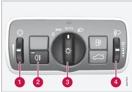
Übersicht Schalterfeld Beleuchtung.
