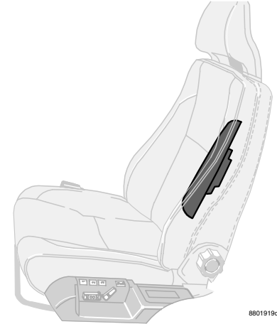
Die Seitenaufprall-Airbags sind im Rahmen der Vordersitzrücklehnen eingebaut
