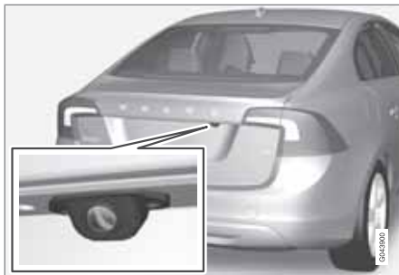
Position der Kamera am Öffnungsriff.
