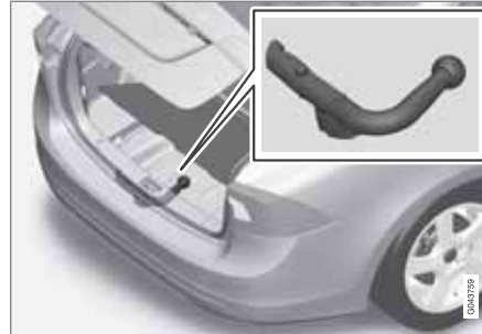
Aufbewahrungsort der Anhängerzugvorrichtung.
