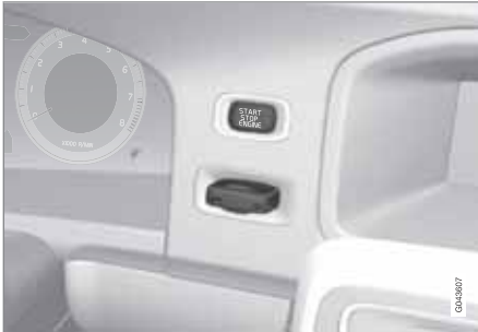
Zündschloss mit eingedrücktem Transponderschlüssel.
