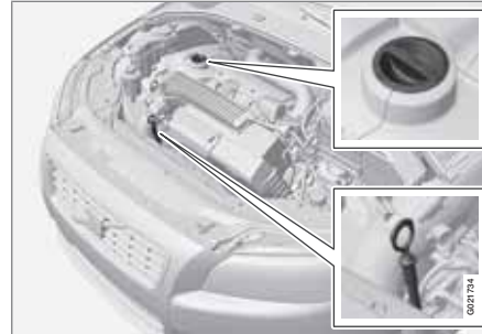
Messstab und Einfüllrohr, Benzinmotor.
