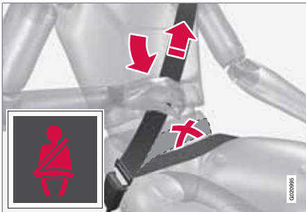
Korrekt angelegter Sicherheitsgurt.
