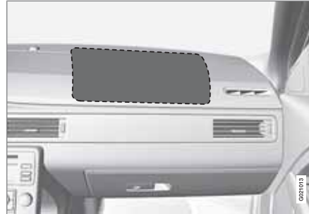
Position des Beifahrerairbags in Linkslenkern.
