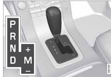
D: Automatische Gangstellungen. M (+/-): Manuelle Gangstellungen.
