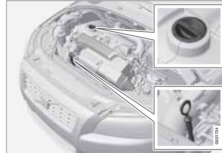
Messstab und Einfüllrohr, Benzinmotor.
