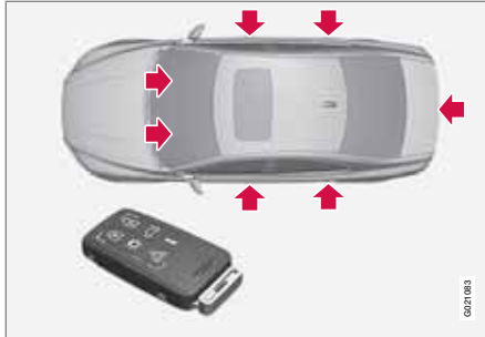
Verriegelungspunkte für Transponderschlüssel mit Schlüsselblatt.
