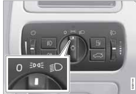
Lichtschalter in Stellung für Positionsluchten/Standlicht.
