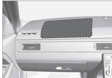
Position des Beifahrerairbags in Rechtslenkern.
