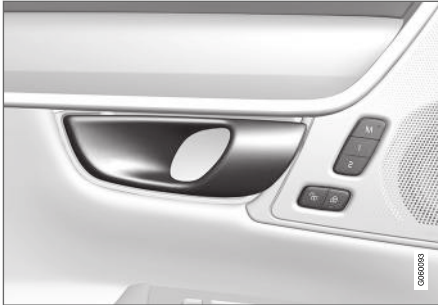
Griff zum alternativen Entriegeln der Tür 12 .
