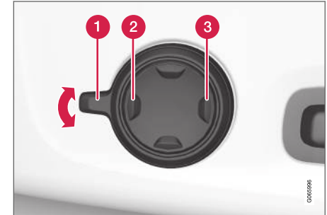
Multifunktionsschalter an der Seite des Sitzpolsters.
