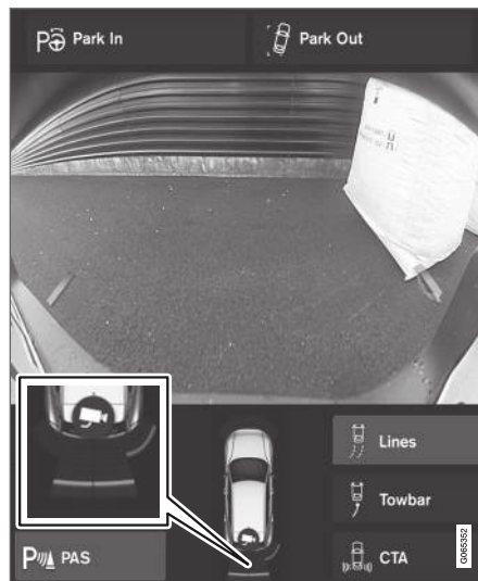
Der Bildschirm kann auf dem Fahrzeugsymbol farbige Sensorfelder darstellen.
