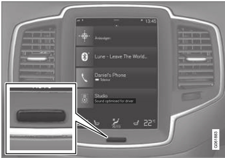
Home-Taste des Displays in der Mittelkonsole.
