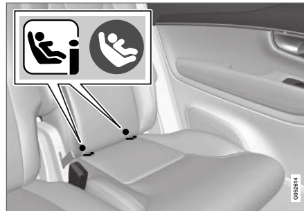
Lage der Befestigungspunkte in der zweiten Sitzreihe.
