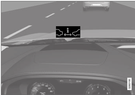
Symbol für Abstandswarnung auf der Windschutzscheibe mit Head-up-Display.
