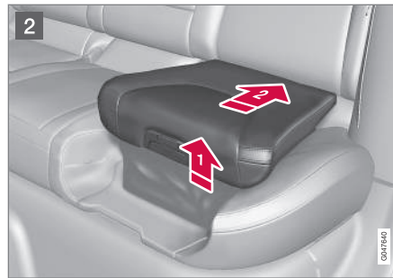
2 Das Sitzkissen an der Vorderkante anheben und zum Verriegeln nach hinten gegen die Rückenlehne drücken.
