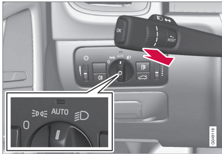
Lenkradhebel und Lichtschalter-Drehregler in Stellung AUTO .
