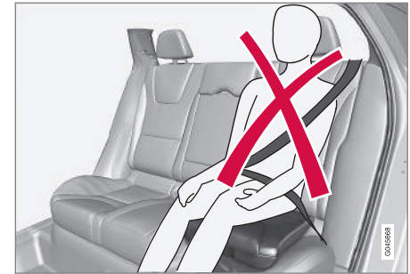
Falsche Position, der Gurt darf nicht unterhalb der Schulter verlaufen.
