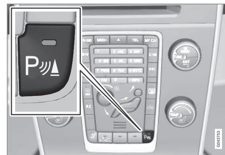
Ein/Aus für die Einparkhilfe und CTA*.
