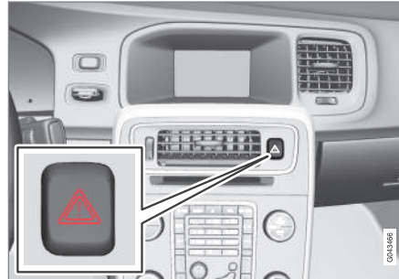
Taste für Warnblinkanlage.
