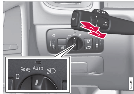
Lenkradhebel und Lichtschalter-Drehregler.
