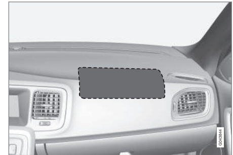
Position des Beifahrerairbags in Linkslenkern.
