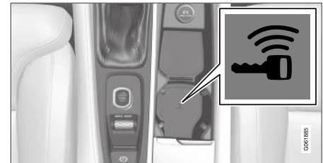
Lage des Schlüssellesegeräts in der Tunnelkonsole.
