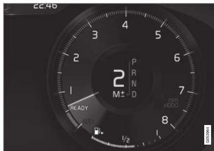
Manuelle Schaltstellung im Fahrerdisplay 3 .
