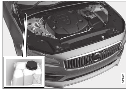
Ausgleichsbehälter der Kühlanlage, Rechtslenker.
