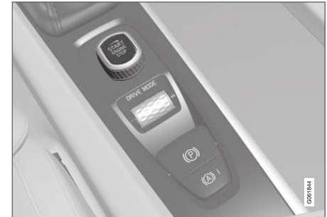
Startschalter auf der Tunnelkonsole.
