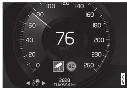
Radarkamerawarnung auf dem Fahrerdisplay 110 .
