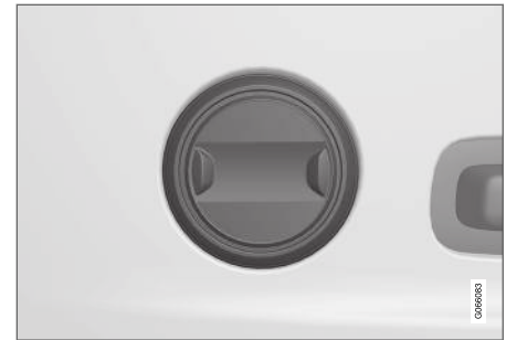
Bedienelement in Fahrzeugen mit Zwei-Wege-Lendenwirbelstütze*.
