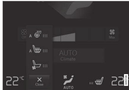
Lenkrad- und Sitztasten in der Klimaleiste.
