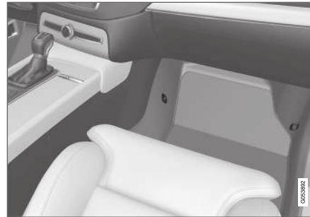
Lage der Befestigungspunkte für den Vordersitz
