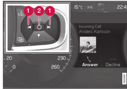
Meldung auf dem Fahrerdisplay 7 und rechtes Lenkradtastenfeld.
