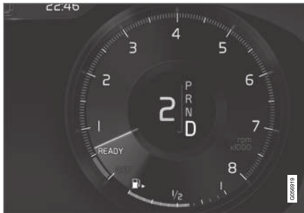
Fahrerdisplay beim Schalten mit den Schaltwippen.
