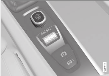
Startschalter auf der Tunnelkonsole.
