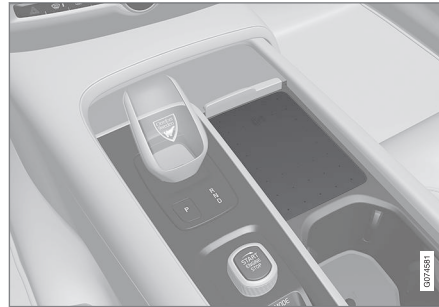
Drahtlos-Telefonladegerät in der Tunnelkonsole.
