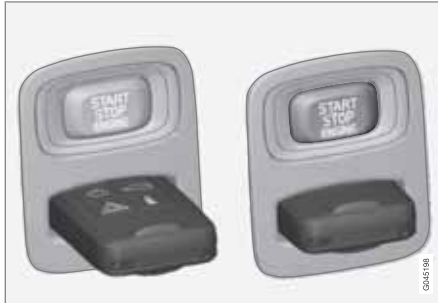
Zündschloss mit herausgezogenem/eingedrücktem Transponderschlüssel.
