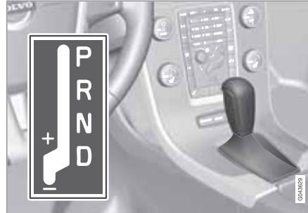
D: Automatische Gangstellungen. +/-: Manuelle Gangstellungen.
