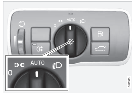
Drehregler des Lichtschalters in Stellung AUTO .
