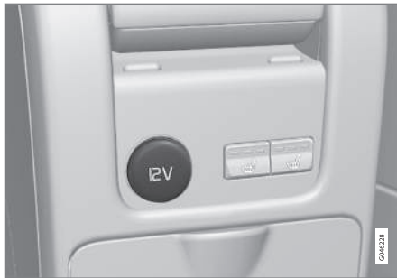
12-V-Steckdose in der Tunnelkonsole, Fond.
