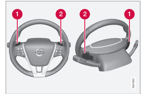
Die beiden "Schaltwippen" des Lenkrads.
