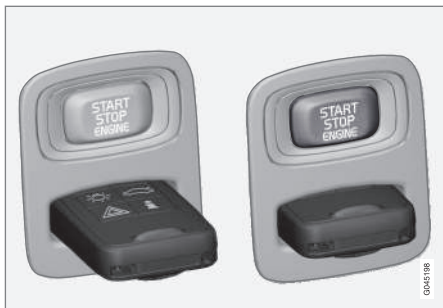
Zündschloss mit herausgezogenem/eingedrücktem Transponderschlüssel.
