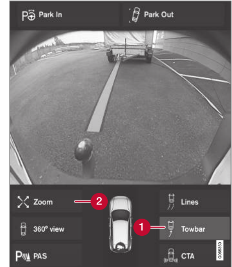
Anhängerkupplung mit Hilfslinie.
