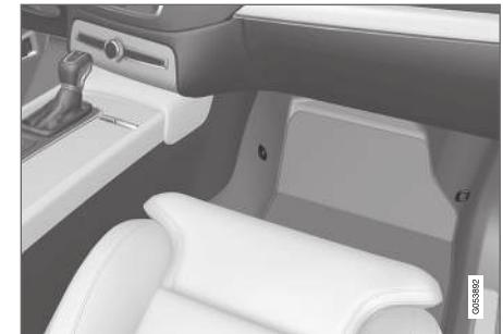
Lage der Befestigungspunkte für den Vordersitz
