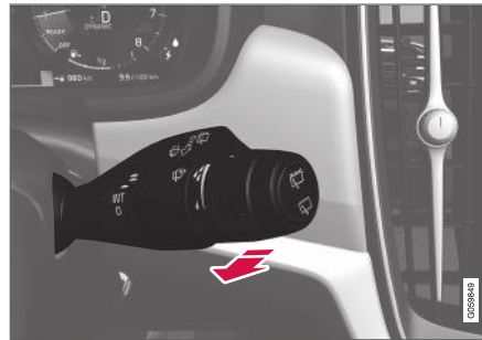
Waschfunktion, rechter Lenkradhebel.
