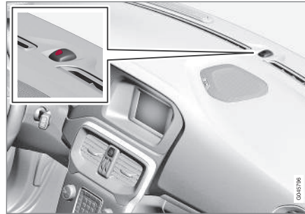
Gleiche Diode wie die der Alarmanzeige (S. 185).
