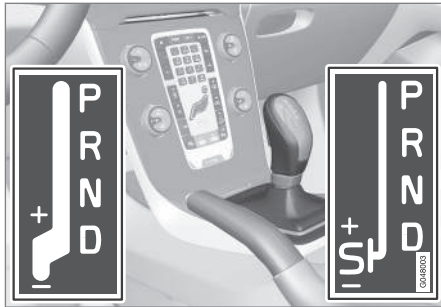
D: Automatische Gangstellungen. +/-: Manuelle Gangstellungen. S: Sportmodus 7
