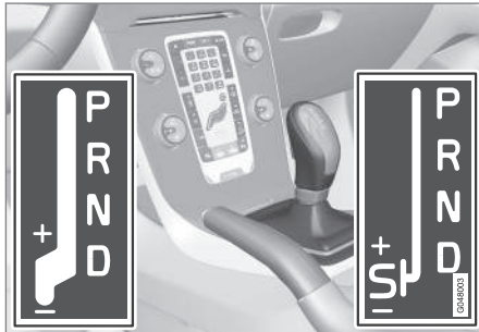
D: Automatische Gangstellungen. +/-: Manuelle Gangstellungen. S: Sportmodus 12
