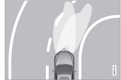
Lichtverteilung bei deaktivierter (links) bzw. aktivierter Funktion (rechts).
