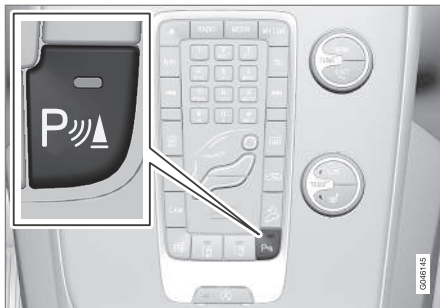
Ein/Aus der Sensoren der Einparkhilfe und von CTA 25 .
