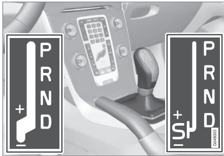
D: Automatische Gangstellungen. +/-: Manuelle Gangstellungen. S: Sportmodus*. 10
