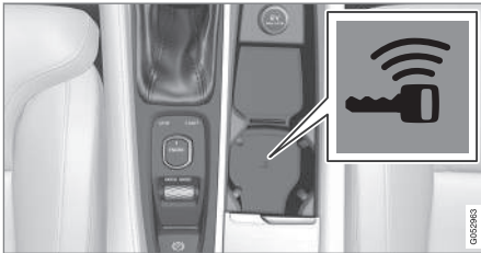
Lage des Schlüssellesegeräts in der Tunnelkonsole.
