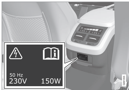
230-V-Steckdose in der Tunnelkonsole, Rücksitz.
