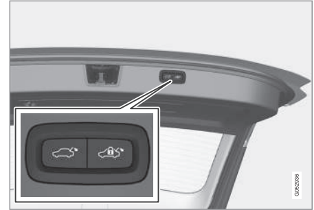
Taste zum Schließen und Verriegeln am unteren Rand der Heckklappe.
