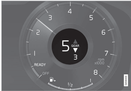
Schaltanzeige auf dem 12-Zoll-Fahrerdisplay.
