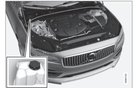
Ausgleichbehälter der Kühlanlage, Linkslenker.
