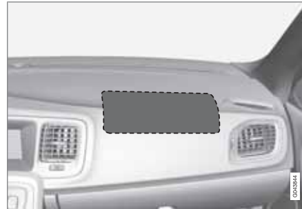
Position des Beifahrerairbags in Linkslenkern.
