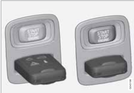
Zündschloss mit herausgezogenem/eingedrücktem Transponderschlüssel.
