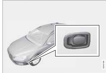
Steckdose für Motorheizung.
