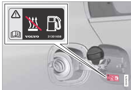
Warnaufkleber auf der Kraftstofftankklappe.
