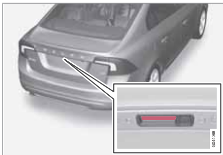
Gummiplatte mit elektrischem Anschluss.
