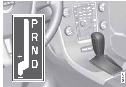
D: Automatische Gangstellungen. +/-: Manuelle Gangstellungen.
