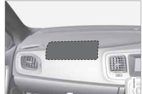
Position des Beifahrerairbags in Rechtslenkern.
