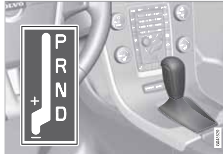
D: Automatische Gangstellungen. +/-: Manuelle Gangstellungen.
