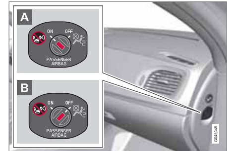
Position des Schalters.
