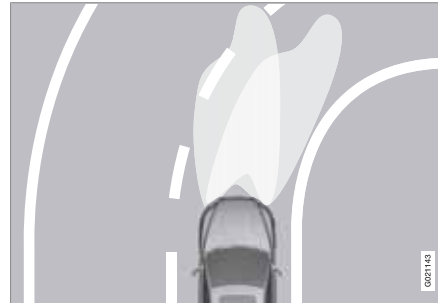
Lichtmuster bei deaktivierter (links) bzw. aktivierter Funktion (rechts).
