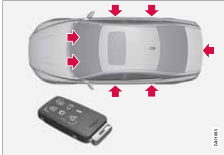
Verriegelungspunkte für Transponderschlüssel mit Schlüsselblatt.
