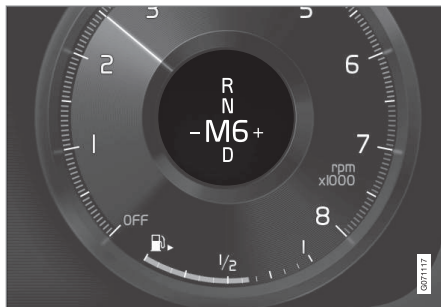
Schaltmuster auf dem Fahrerdisplay bei kleinem Wählhebel.
