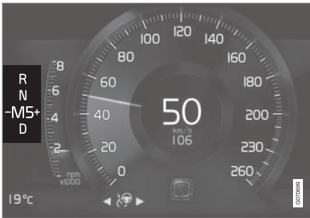
Schaltanzeige auf dem 8-Zoll-Fahrerdisplay bei kleinem Wählhebel.
