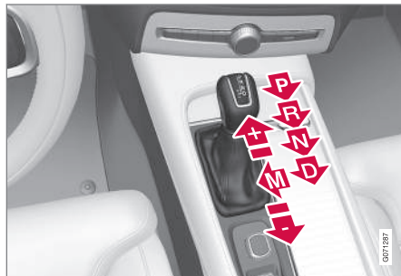
Übersicht über den großen Wählhebel und Schaltstellungen.
