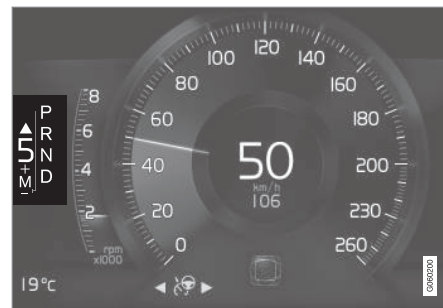
Schaltanzeige auf dem 8-Zoll-Fahrerdisplay bei großem Wählhebel.
