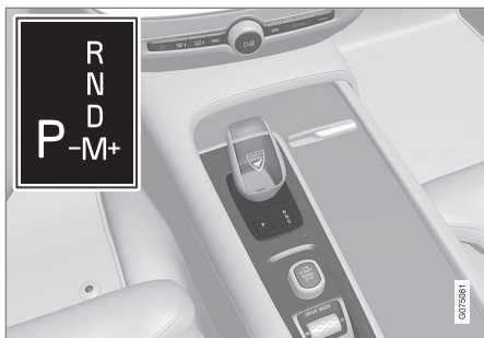
Kleiner Wählhebel und Schaltmuster auf dem Fahrerdisplay.
