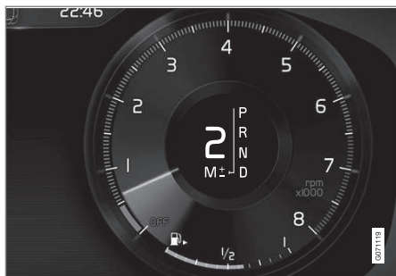
Schaltmuster auf dem Fahrerdisplay bei großem Wählhebel.
