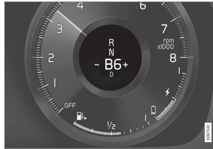
Schaltanzeige im Fahrerdisplay 5 .
