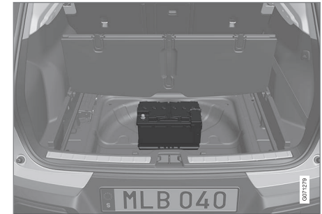
Die Startbatterie befindet sich im Kofferraum.
