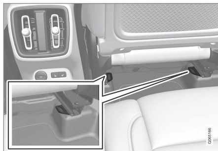
Lage der Befestigungspunkte für den Rücksitz.
