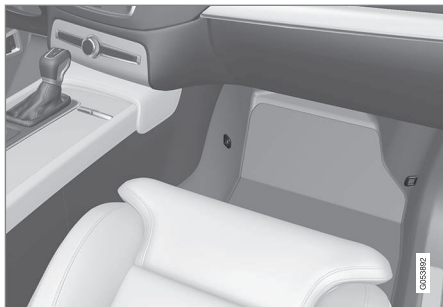
Lage der Befestigungspunkte für den Vordersitz
