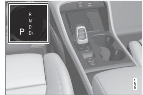
Wählhebel und Schaltmuster auf dem Fahrerdisplay.
