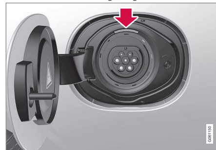
Position der LED-Leuchte am Ladeanschluss des Fahrzeugs.
