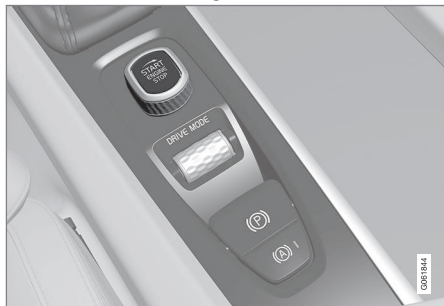
Startschalter auf der Tunnelkonsole.
