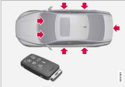
Verriegelungspunkte für Transponderschlüssel mit Schlüsselblatt.
