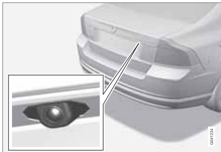
Position der Kamera am Öffnungsriff.
