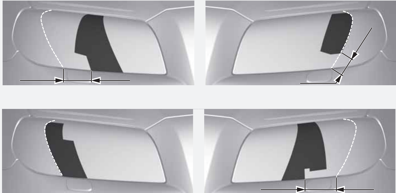
Obere Reihe: Linkslenker, Schablonen A und B. Untere Reihe: Rechtslenker, Schablonen C und D.
