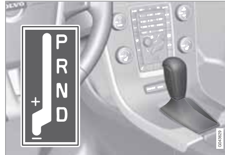
D: Automatische Gangstellungen. +/-: Manuelle Gangstellungen.
