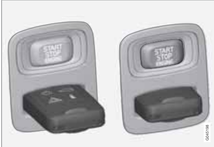
Zündschloss mit herausgezogenem/ingedrücktem Transponderschlüssel.
