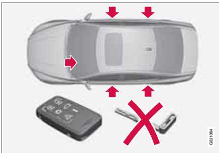
Verriegelungspunkte für Transponderschlüssel ohne Schlüsselblatt und aktivierter Geheimverriegelung.
