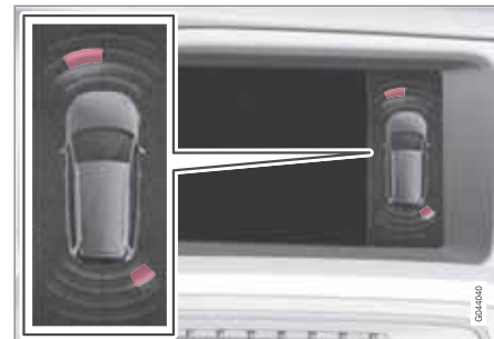
Bildschirmanzeige – zeigt Hindernisse links vorn und rechts hinten an.
