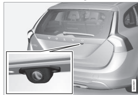
Position der Kamera am Öffnungsgriff.
