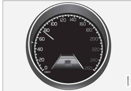
Seitenstreifen der LDW-Funktion.
