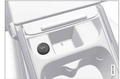
12-V-Steckdose in der Tunnelkonsole, Vordersitz.
