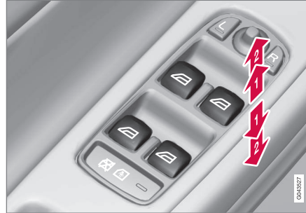
Betätigung der Fensterheber.
