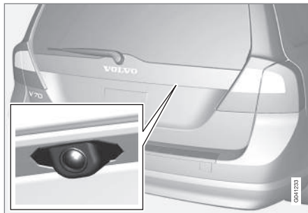
Position der Kamera am Öffnungsgriff.
