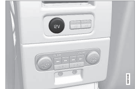
12-V-Steckdose in der Tunnelkonsole, Fond.
