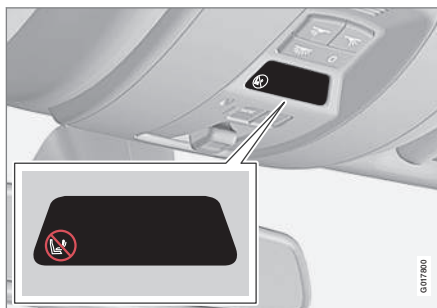
Anzeige, die darauf aufmerksam macht, dass der Beifahrerairbag aktiviert ist.
