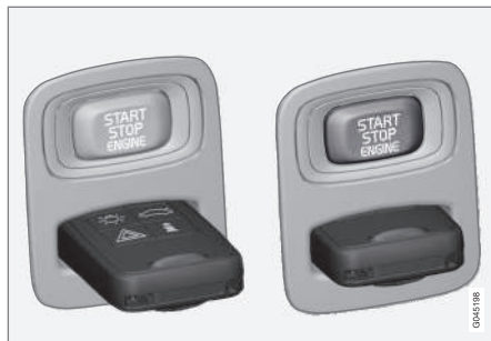
Zündschloss mit herausgezogenem/eingedrücktem Transponderschlüssel.
