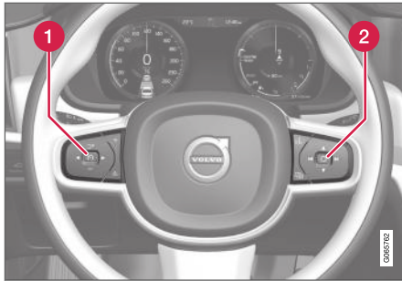
Tastenfelder und Schaltwippen* am Lenkrad.
