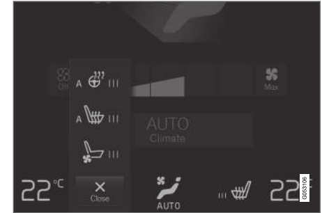
Lenkrad- und Sitztasten in der Klimaleiste.
