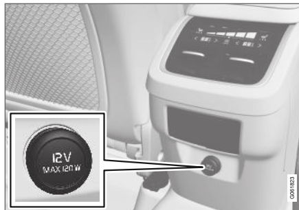
12-V-Steckdose in der Tunnelkonsole, Rücksitz.
