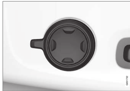
Multifunktionsschalter, in Fahrzeugen mit Vier-Wege-Lendenwirbelstütze*.
