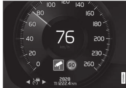
Radarkamerawarnung auf dem Fahrerdisplay 111 .
