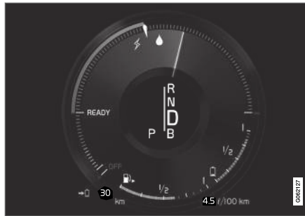
Fahrerdisplay bei Antrieb durch Elektro- und Verbrennungsmotor.
