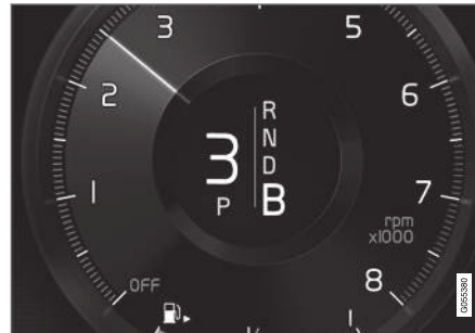
Schaltstellung B auf dem Fahrerdisplay.
