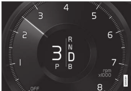
Fahrerdisplay beim Schalten mit den Schaltwippen.
