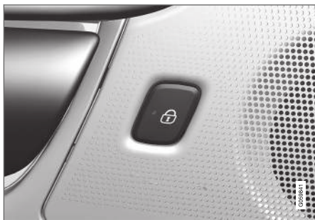
Verriegelungstaste mit Anzeigeleuchte an der Hintertür.
