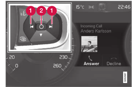
Meldung auf dem Fahrerdisplay und rechtes Lenkradtastenfeld.
