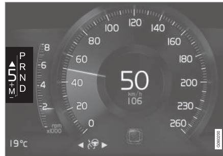
Schaltanzeige auf dem 8-Zoll-Fahrerdisplay bei großem Wählhebel.
