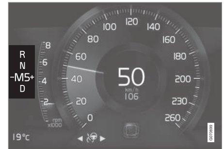
Schaltanzeige auf dem 8-Zoll-Fahrerdisplay bei kleinem Wählhebel.
