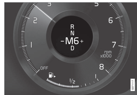
Schaltmuster auf dem Fahrerdisplay bei kleinem Wählhebel.
