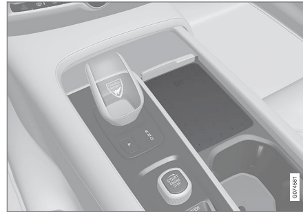
Drahtlos-Telefonladegerät in der Tunnelkonsole.
