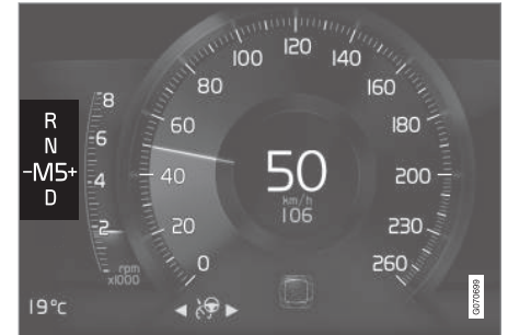
Schaltanzeige auf dem 8-Zoll-Fahrerdisplay bei kleinem Wählhebel.
