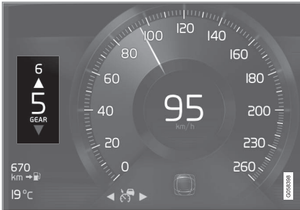
Schaltanzeige auf dem 8-Zoll-Fahrerdisplay.
