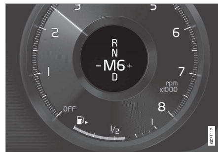
Schaltmuster auf dem Fahrerdisplay bei kleinem Wählhebel.
