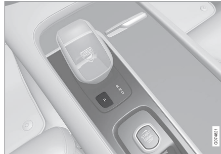
Übersicht Wählhebel und Schaltstellung P bei kleinem Wählhebel.
