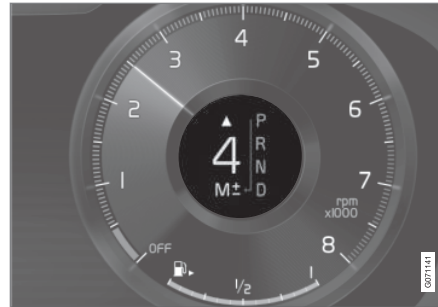
Schaltanzeige auf dem 12-Zoll-Fahrerdisplay bei großem Wählhebel*.
