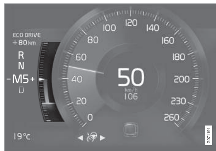
Eco-Anzeige auf dem 8-Zoll-Fahrerdisplay.
