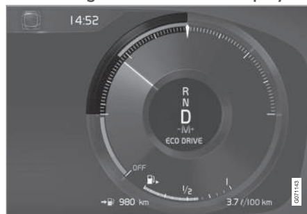
Eco-Anzeige auf dem 12-Zoll-Fahrerdisplay*.
