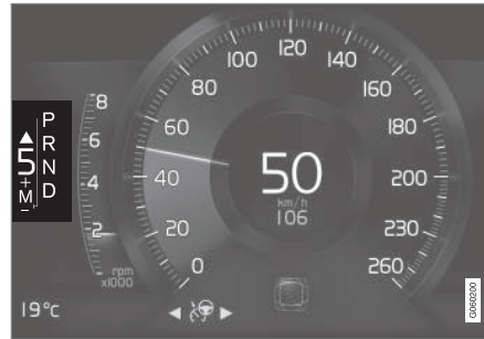
Schaltanzeige auf dem 8-Zoll-Fahrerdisplay bei großem Wählhebel.
