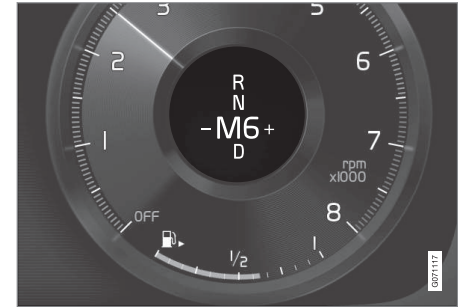
Schaltanzeige auf dem 12-Zoll-Fahrerdisplay bei kleinem Wählhebel*.
