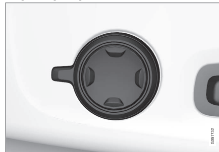
Seitlich am Sitzpolster angebrachter Multifunktionsschalter.
